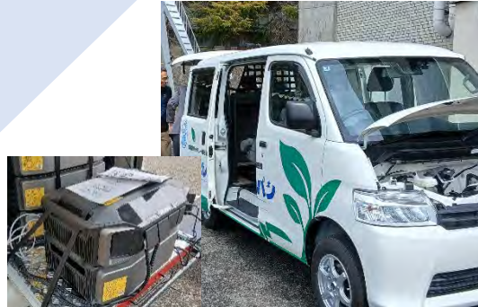
災害対策用移動電源車(エレバン)
