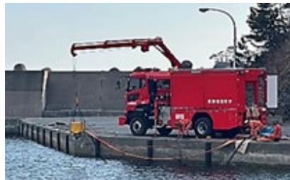
【スーパーポンパー(海水利用型消防水利システム)】
