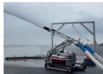
【無人走行放水ロボット】
