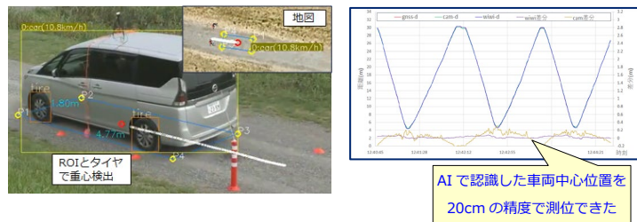
図 9 多点測位システムの交通インフラへの展開
