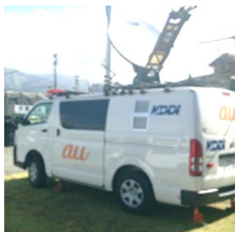
車載型基地局 【設備故障・倒壊対策】
