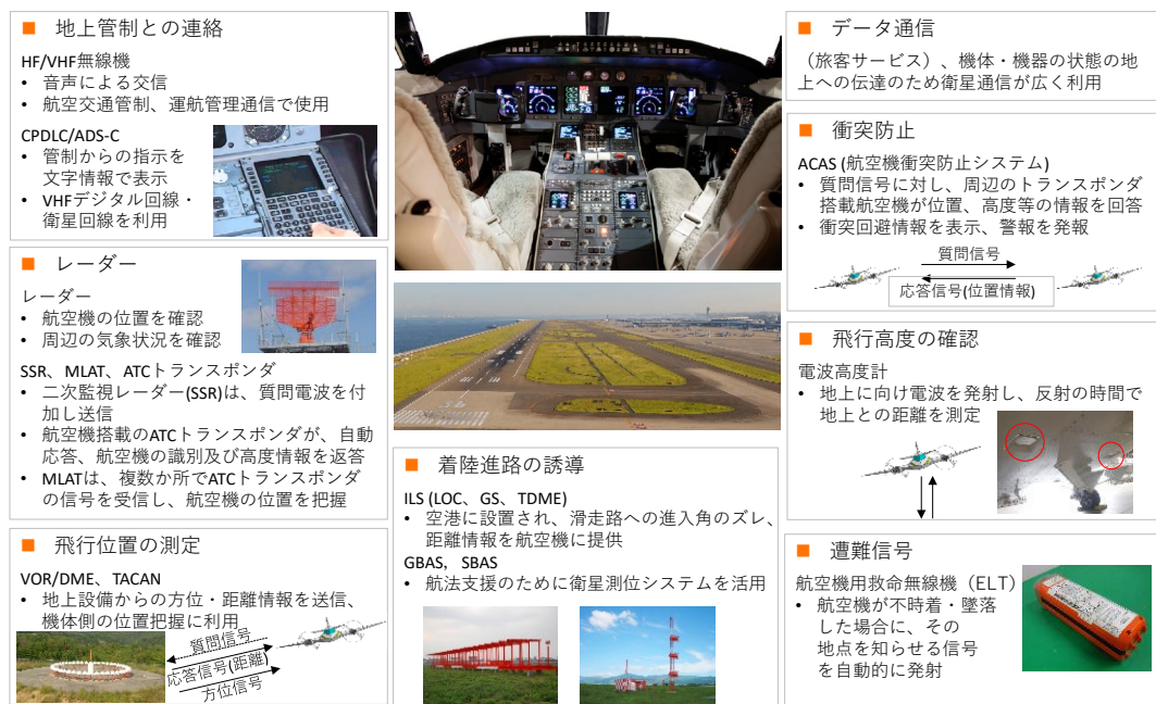
図 13 航空機に関連する主な無線システム 19
