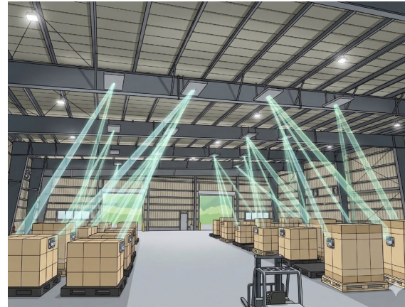
環境 : 窓・搬入出口のある倉庫 天井から斜め下方向に給電 給電対象 : 荷物のトラッキング・センシングデバイス
