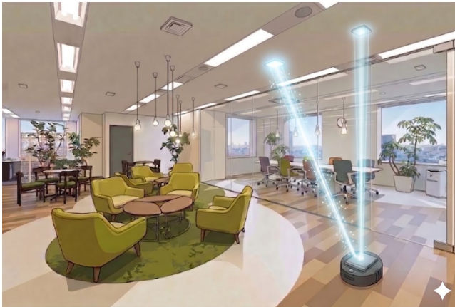
環境 : 窓のあるオフィス 床に設置した移動アンテナから天井に向けて給電 給電対象 : 天井に後付けしたセンシングデバイス
