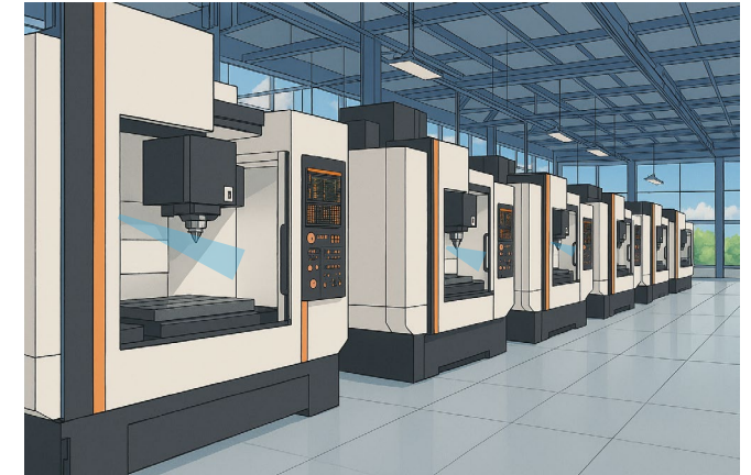
環境 : 窓のある工場・窓のある工作機械内部 工作機械壁面から斜め下方向に給電 給電対象 : 可動部へ取り付けるセンサ、アクチュエータ
