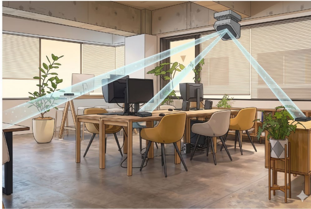
環境 : 窓のあるオフィス 天井から斜め下方向に給電 給電対象 : 卓上の電子デバイス
