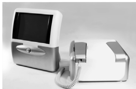
開発したソフトウェア無線機の外観図 左: 表示部(カメラによる動画撮影機能付き、 右: 無線信号処理部)
