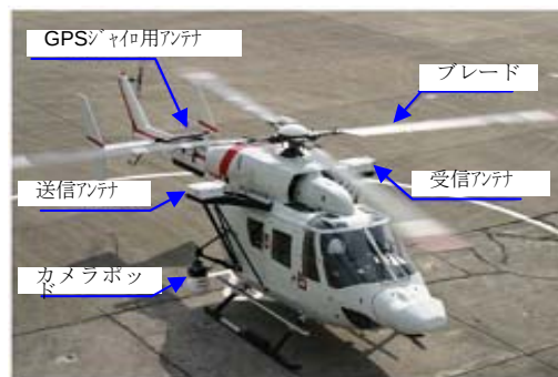
(図1) 衛星通信システムを搭載したヘリコプター
