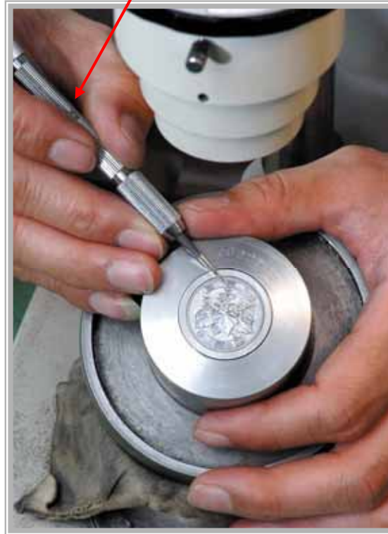
500円用極印 (種印) の修正作業
