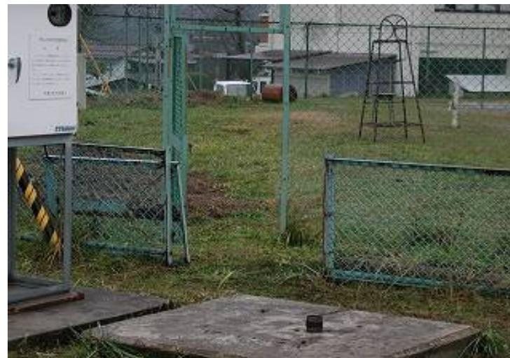
観測所のフェンスが破損しており、超音波式積雪計の測定範囲内に人や動物が入り込み観測に影響が出ることが懸念される
