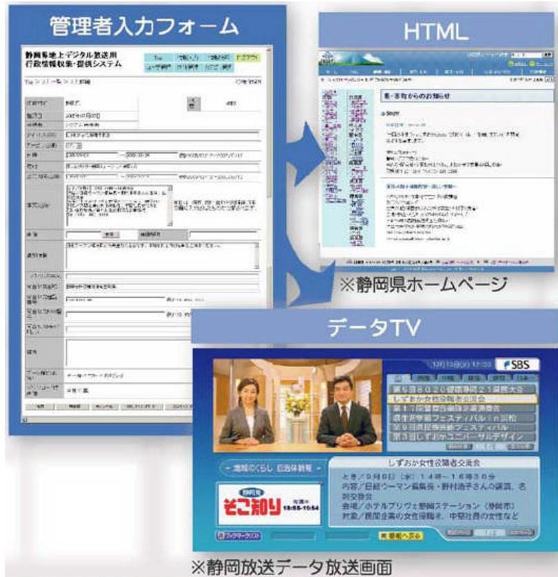
図表 2.2-2 静岡県の地上デジタル放送用行政情報収集・提供システムの構成
