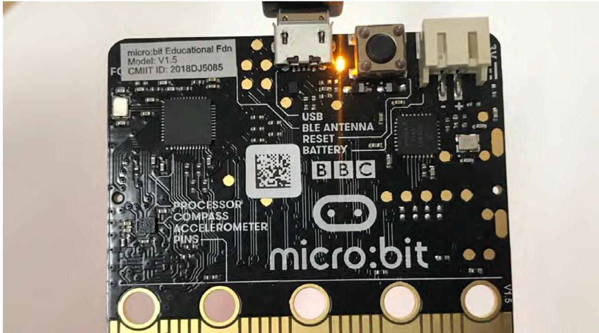
写真は電源が入った状態です。電源が入った状態にするにはこれも付属品でついてくるmicroUSBケーブルでパソコンと繋がります。micro:bitは電池でも動かさせますが、今回はパソコンとつないで利用します。繋ぐとこのように光るのです。
