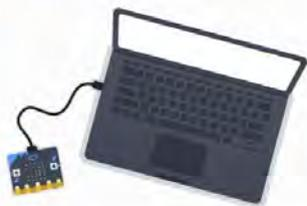
micro:bitをコンピューターとUSBケーブルで接続します。
