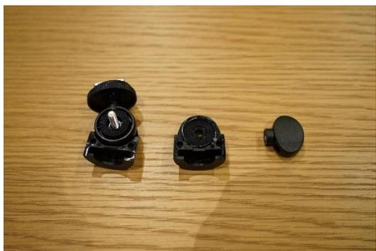
コネクタ部品のネジを外し、バラバラにします。
