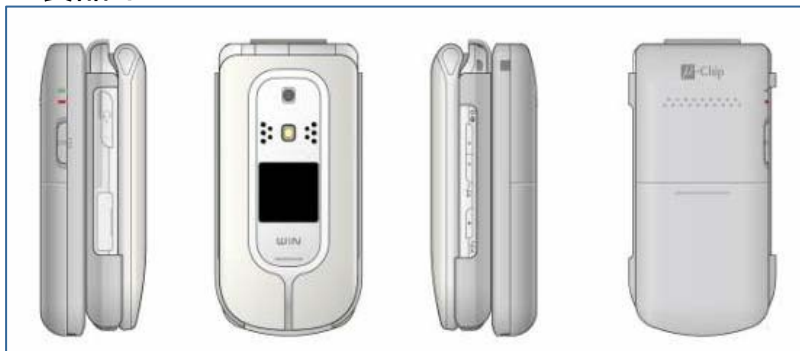
【イメージ】携帯電話-RFIDリーダ一体接続状態の四面図
