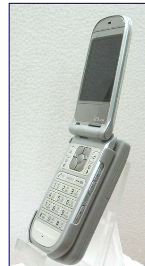
【写真】RFIDリーダ単体写真(左)と 携帯電話-RFIDリーダ一体接続状態写真(右)
