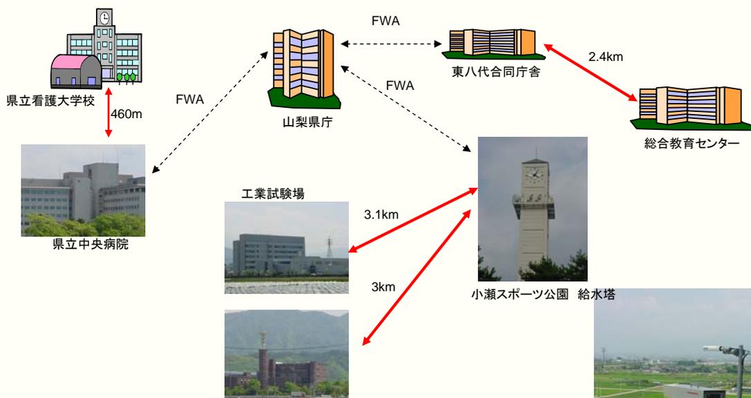
山梨県広域通信ネットワークは、防災無線をベースに構築されています。しかし、防災無線の周波数は、有限であるため、一部の区間に光無線を使用しています。
