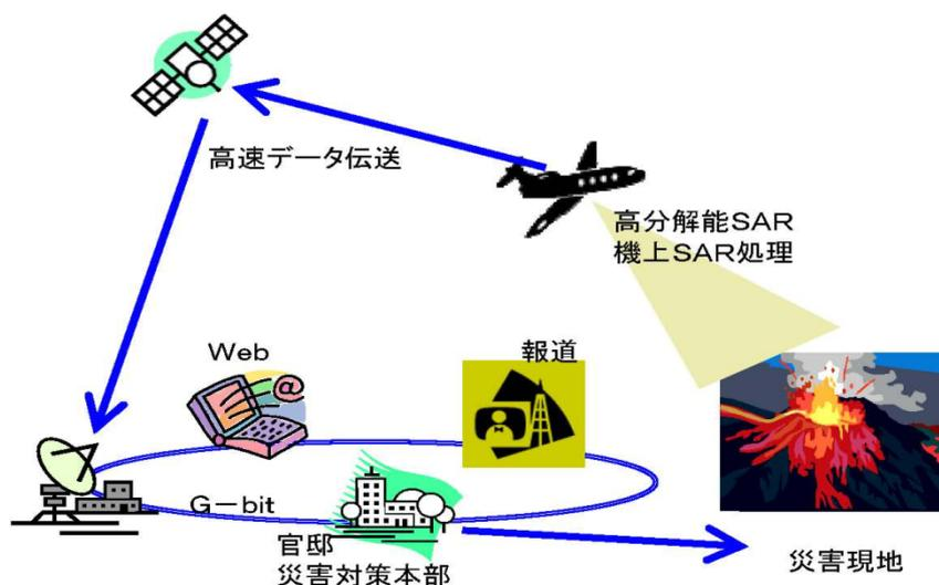
図5：航空機搭載合成開口レーダデータ配信の概念図
