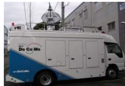
衛星エントランス移動基地局車
