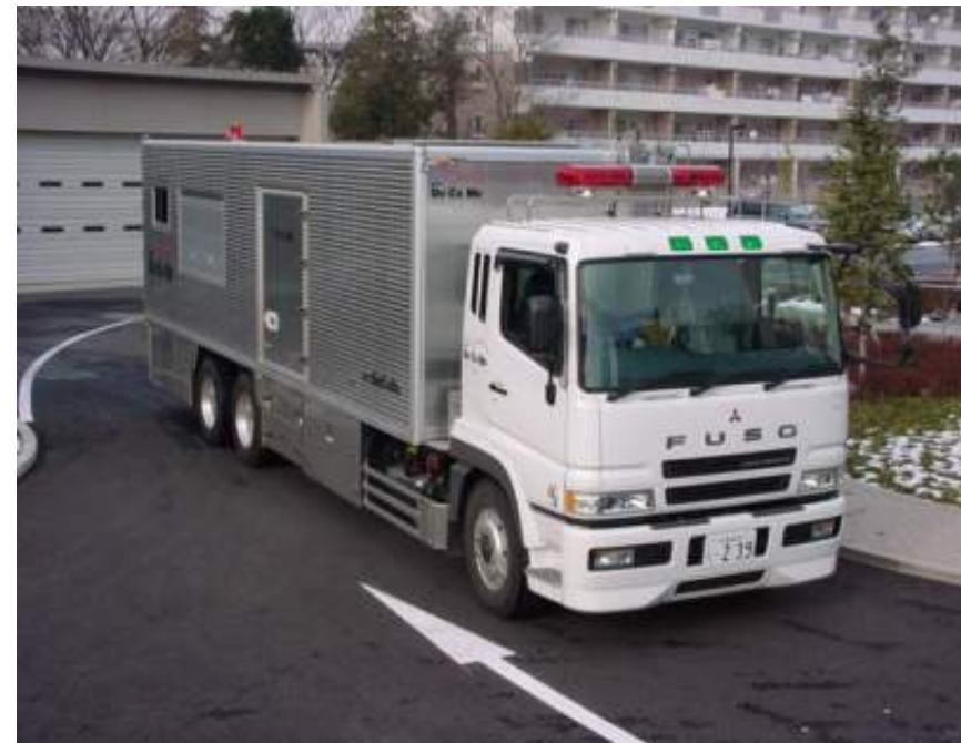
大型移動電源車
