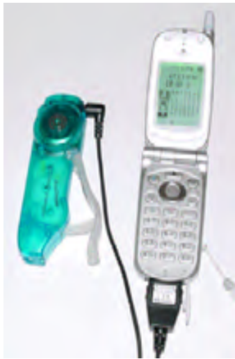
【携帯電話用手動発電機】 約1～1.5Wの出力 約600円
