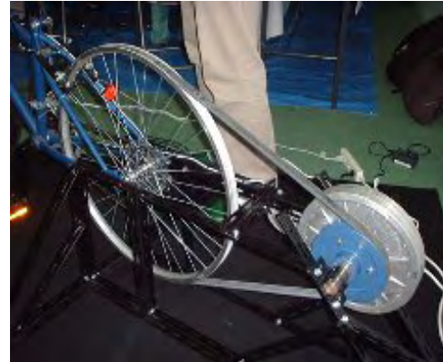
【自転車による足こぎ発電機】 2.4W、3Wまたは6W (速度15km/hにおいて) ペダル付発電機では約20万円 ハブダイナモのみ3千～1万円
