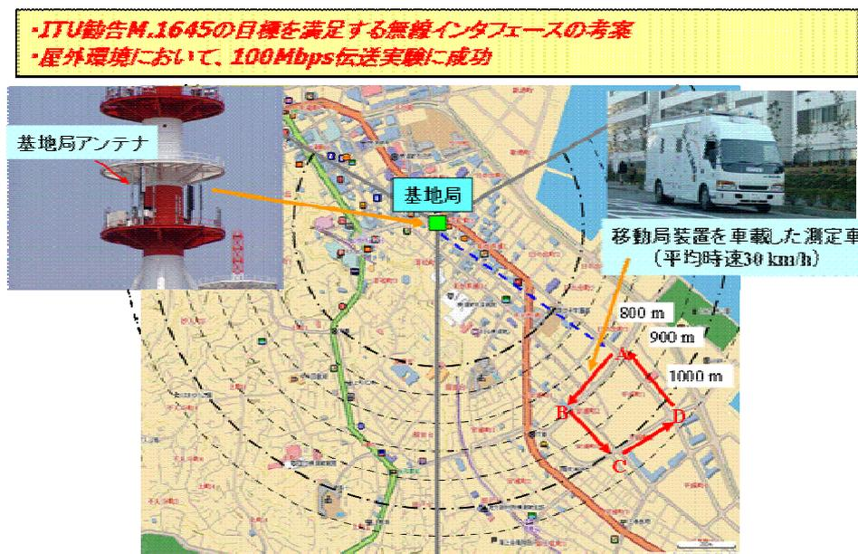
図2-1 新無線インターフェースの伝送実験（NTTドコモ提供）
