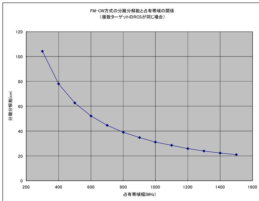
グラフはFM-CW方式における占有帯域幅 ( $\Delta f$ )と分離分解能の関係を示す。
