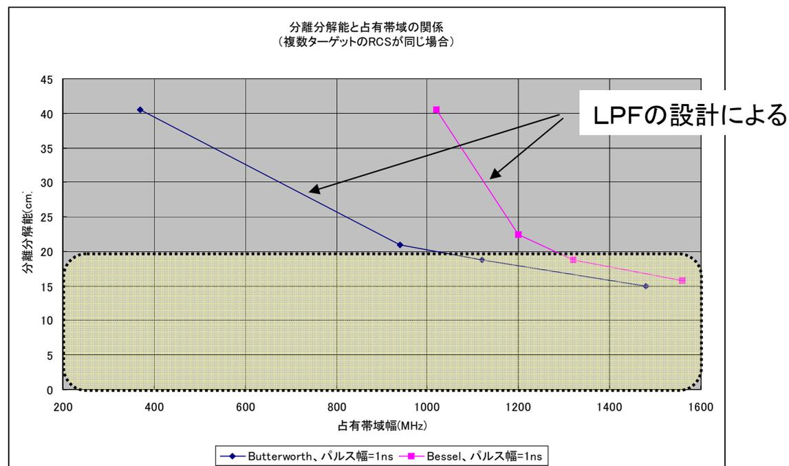
20cm(人体分離に必要な距離) 以下の高分離分解能を実現するためには、占有帯域幅は1.1~1.3 GHz以上の帯域が必要。
