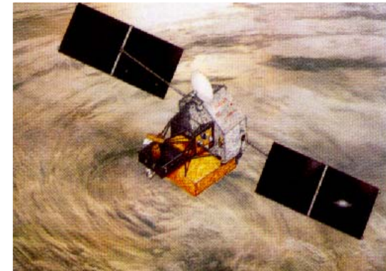
世界初の衛星搭載降雨レーダ が搭載された熱帯降雨観測衛星 (TRMM)
