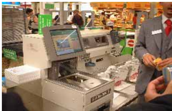
商品のレジ精算。商品バーコードで商品を認識し、商品重量計量で誤精算を防止する。
