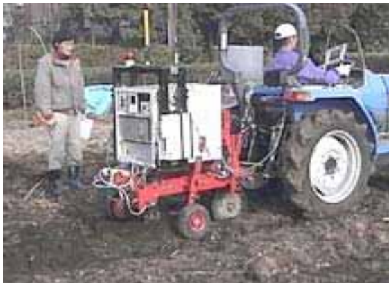
土壌センサー搭載したトラクター概要
