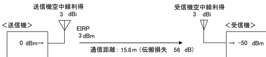
図 参 2-1 空中線電力 1mW における干渉波を考慮した最小の通信距離
