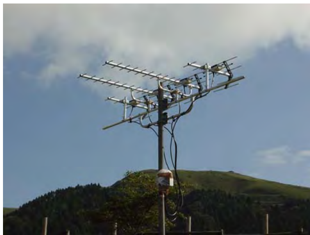
写真 3.1 今回使用した狭指向性アンテナ
