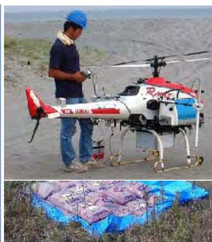
原子力発電所において放射線漏れ事故が発生した場合に備え、無人航空機で人が進入不可能な地域を飛行し、機体に搭載した放射能測定器のデータを無線で地上側に伝送、リアルタイムに放射線量を地図上で確認できるシステムを構築。実験でもごく微量の試験用放射源レベルの確認でき、実用性の高さが実証されている。
