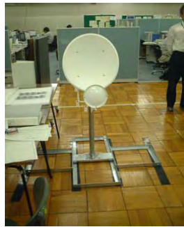
超小型地球局(USAT) 45cmΦ級 送信 1.5、6Mbps 受信155Mbps
