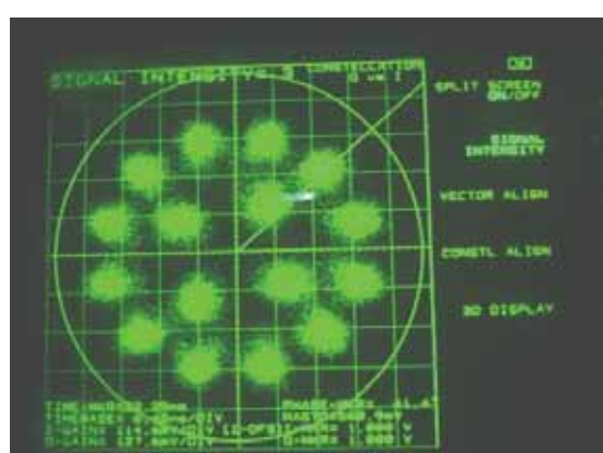
写真 6-2-2 16APSK(1/3) 擬似中継器 折返しのコスタレーション
