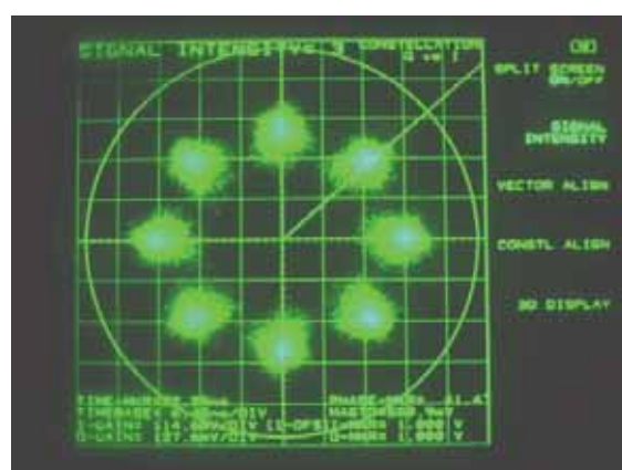
写真 5-2 8PSK 擬似中継器 折返しのコンスタレーション
