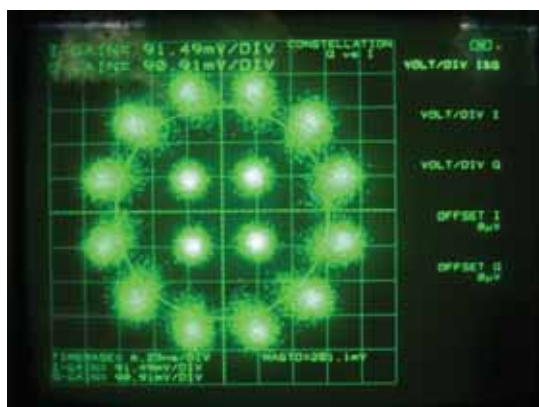
写真 12-7-2 16APSK(3/4) 衛星伝送実験のコンスタレーション
