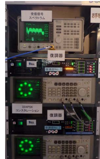
図 41 8PSK 3/4 パルク伝送 受信スペクトラム、コンスタレーション
