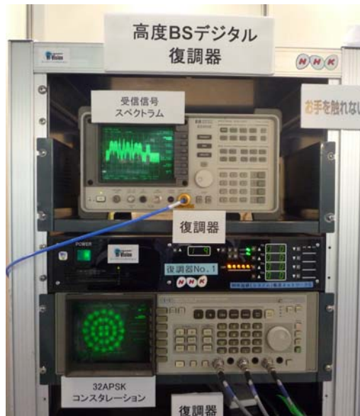
図 40 32APSK 4/5 受信スペクトラム、コンスタレーション
