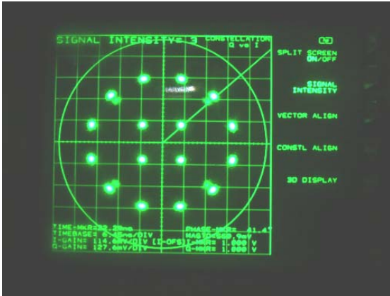
写真 6-9-1 16APSK(5/6) IF 折返しの コンスタレーション
