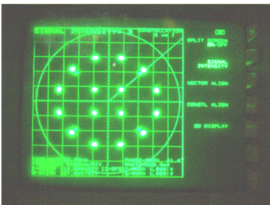
写真 6-11-1 16APSK(9/10) IF 折返しの コンスタレーション
