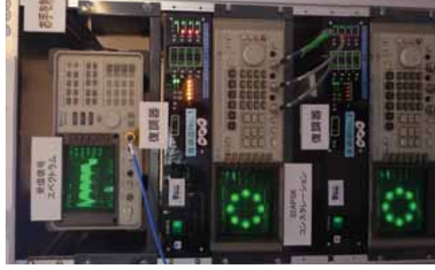
図 41 8PSK 3/4 バルク伝送 受信スペクトラム、コンスタレーション
