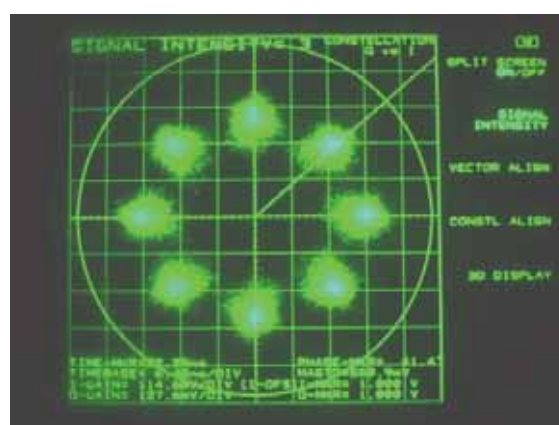
写真 5-2 8PSK 擬似中継器 折返しのコンスタレーション
