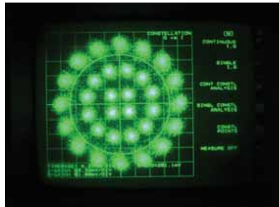
写真 13-5-2 32APSK(3/5) 衛星伝送実験の コンスタレーション
