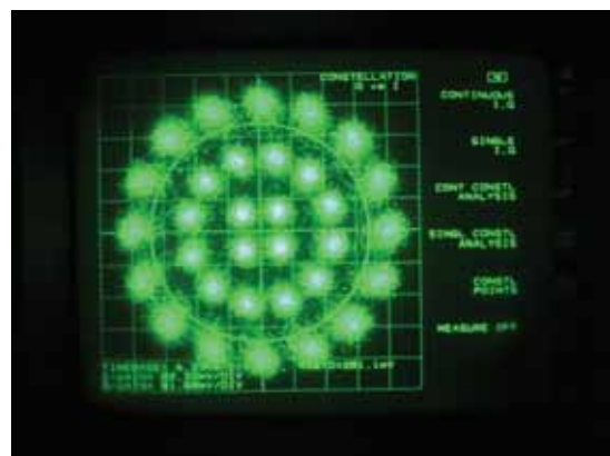
写真 13-6-2 32APSK(2/3) 衛星伝送実験の コンスタレーション
