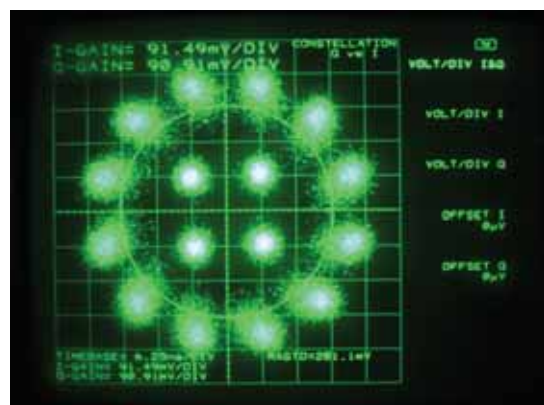
写真 12-3-2 16APSK (2/5) 衛星伝送実験の コンスタレーション
