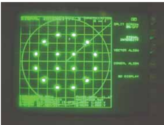
写真 6-11-1 16APSK(9/10) IF 折返しの コンスタレーション
