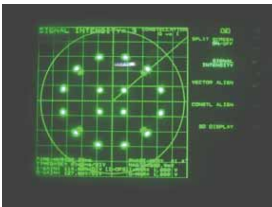
写真 6-7-1 16APSK (3/4) IF 折返しの コンスタレーション
