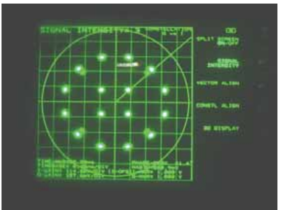
写真 6-8-1 16APSK (4/5) IF 折返しの コンスタレーション
