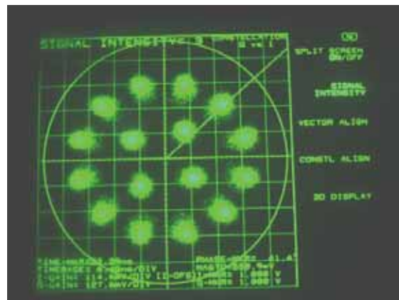
写真 6-11-2 16APSK(9/10) 擬似中継器 折返しのコンスタレーション
