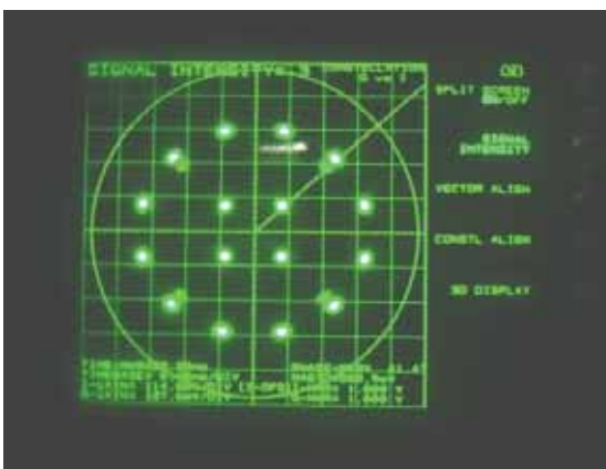
写真 6-5-1 16APSK(3/5) IF 折返しの コンスタレーション
