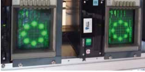
図 47 8PSK 3/4 バルク伝送 コンスタレーション (45cm 径パラポラアンテナ)
