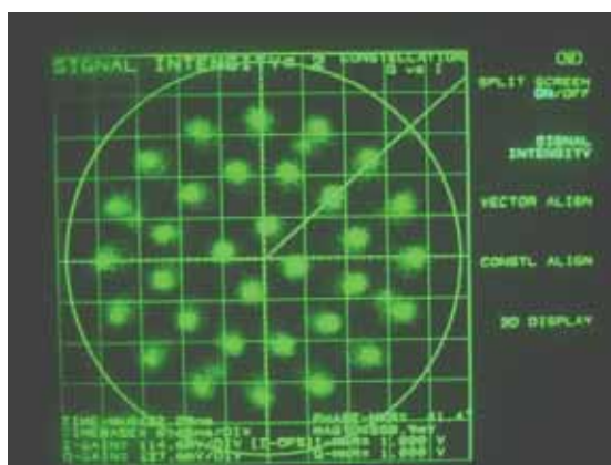
写真 7-10-2 32APSK(7/8) 擬似中継器 折返しのコンスタレーション
