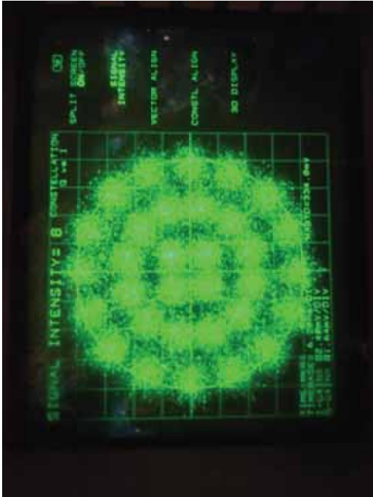
図 46 32APSK 4/5 コンスタレーション (45cm 径パラポラアンテナ)
