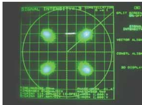
写真 3-5 QPSK 擬似中継器 折返しのコンスタレーション
