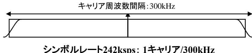
高速化対応システムの下りパケット通信キャリアの配置例
