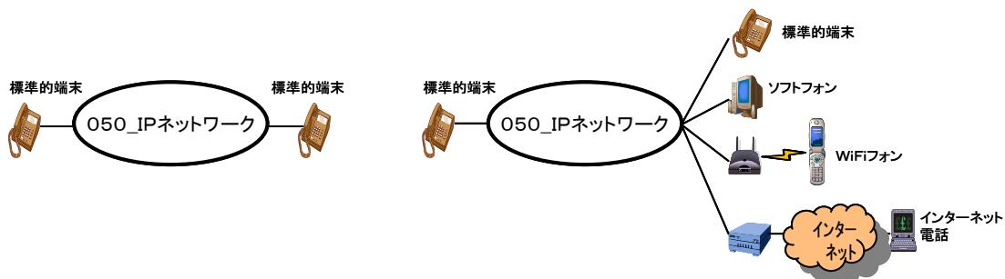
(a) 標準的な端末を接続した形態 (b) 多様な端末を接続した形態
