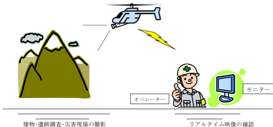
図3. 1. 2-1 画像伝送システムによる空中撮影のイメージ
