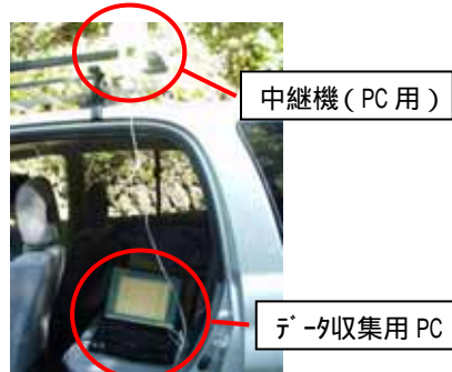
中継機(PC用)～PC(車内)の設置状況
