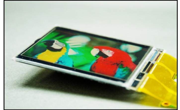
II. 低ギャップECBモード、広視野角円偏光板、光拡散フィルムの最適化により、コントラスト比 60:1、反射率 60%、応答速度 5ms、色再現範囲 55%（実測値）を有する高品位反射型フルカラー液晶ディスプレイを実現した。
