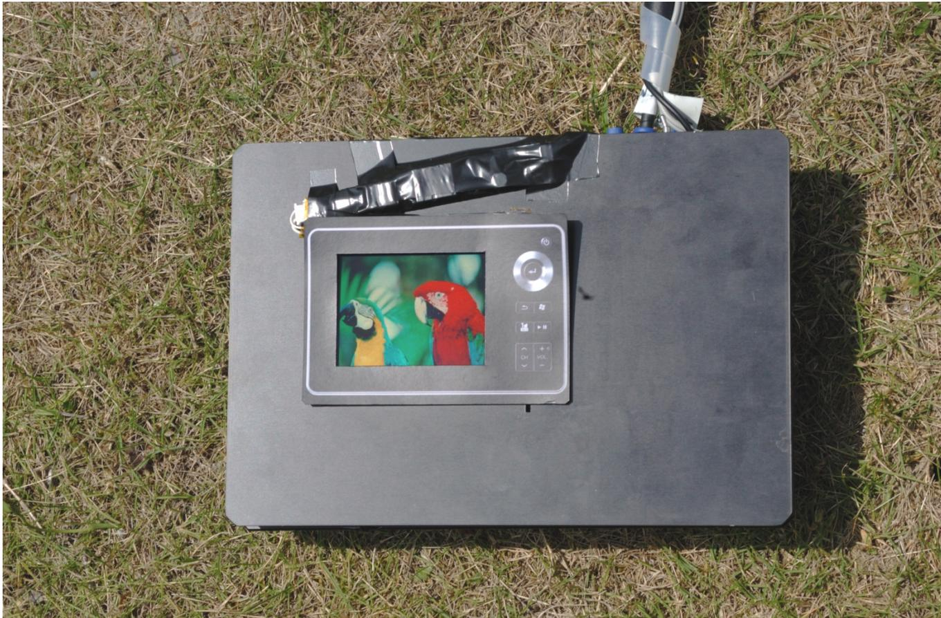
新方式反射型LCD
