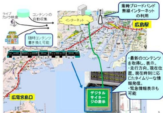
図2 路面電車デジタルサイネージシステム概要
