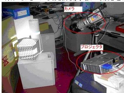
図1 計測システムのプロトタイプ
