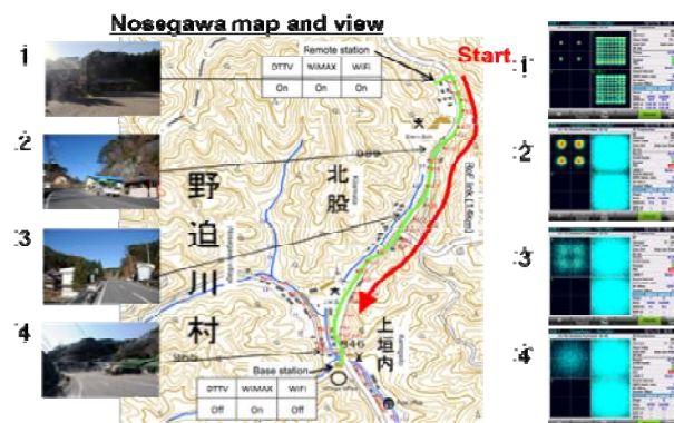
図 2 フィールド試験エリアと 受信地上デジタル放送信号
