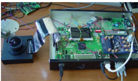
図2 魚眼カメラ及び制御回路の構成 (左：超高速 CMOS 魚眼カメラ、右：FPGA 制御装置)
