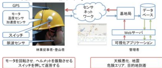
図2 センサネットワークを利用した林業活動におけるウェアラブルシステムの概要
