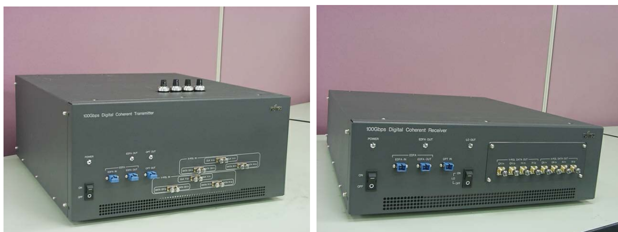
図8 ブレッドボード型光トランシーバ(左：送信部、右：受信部)写真
