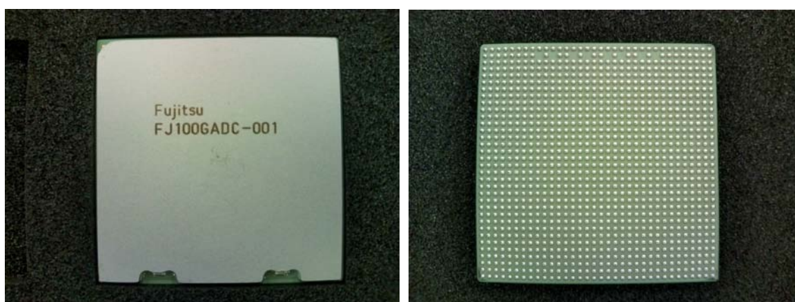
図 6 パッケージ実装検証用試作 (右：表面、左：裏面)
