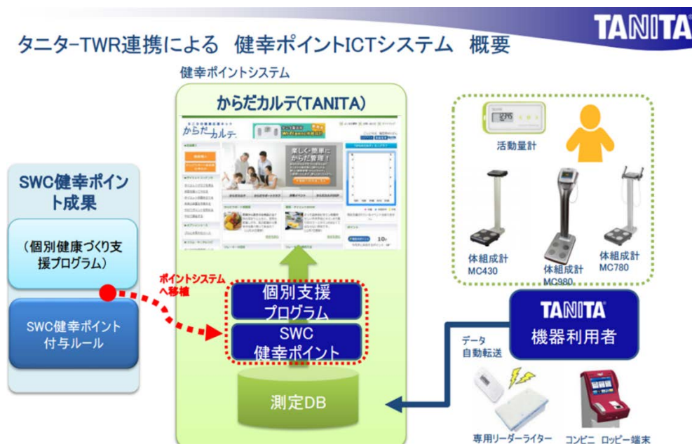
図 6-3 タニタが提供する IoT 健康サービスのシステム概要
