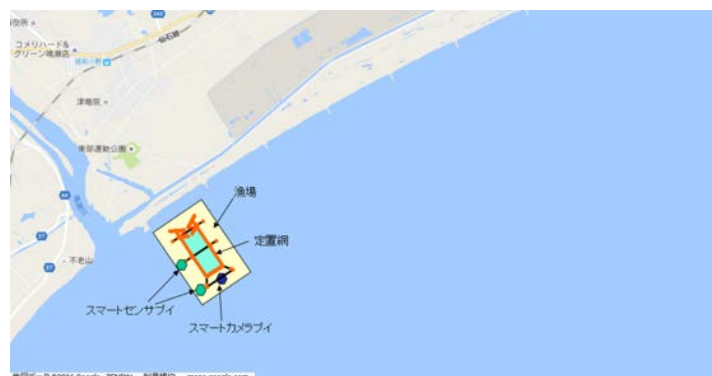
図 4.1.6 漁場ならびにスマートブイ設置箇所
