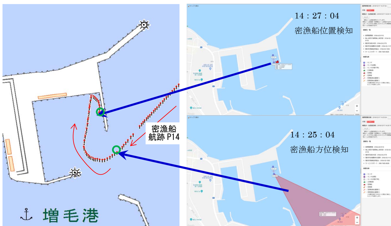
図 4-14 密漁船検出例（カシミール 3 D 及びロコモビ表示図をもとに作成）
