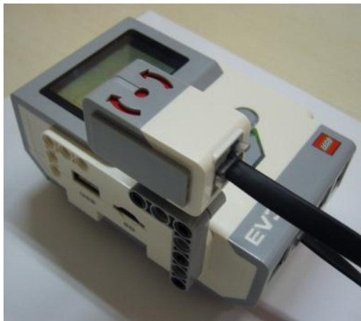
写真1 ジャイロセンサーの取り付け方法例
