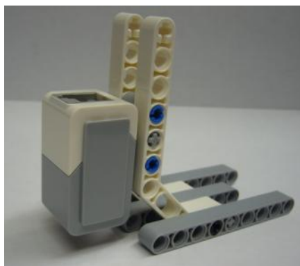
写真5 カラーセンサー(反射モード)固定例
