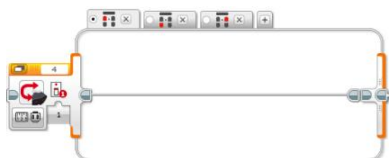
スイッチブロック IRセンサー測定遠隔モードでの多分岐
