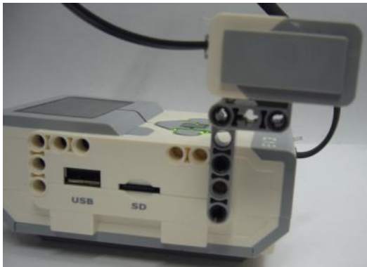
写真3 カラーセンサの取り付け例
