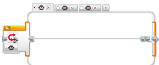
スイッチブロック 本体ボタン測定モードでの多分岐
