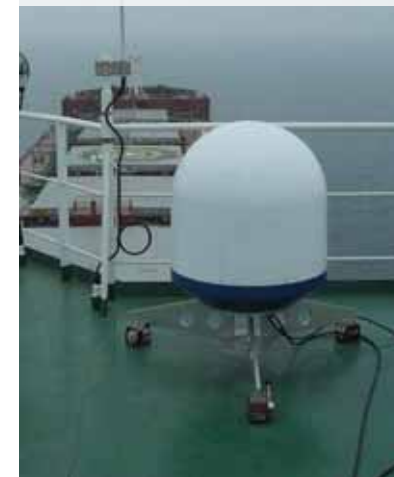
仮設型60cmタイプ 海洋衛星通信サービス向けアンテナの例
