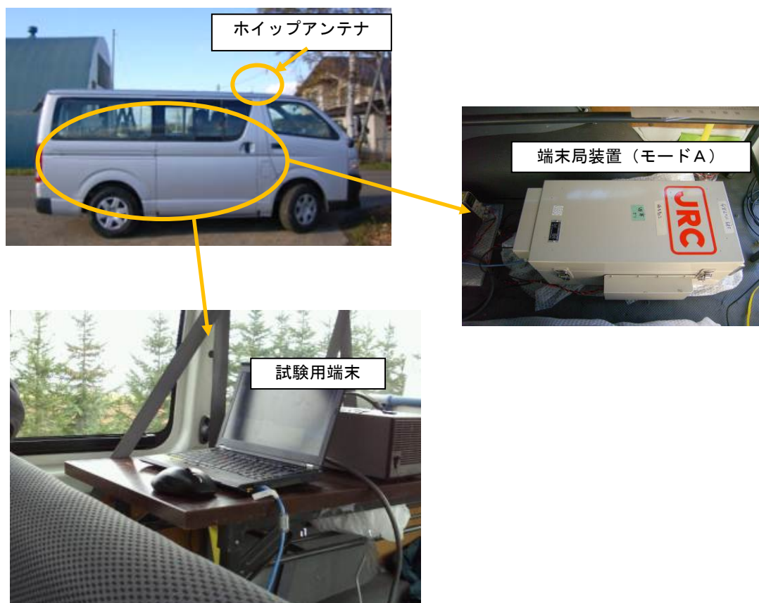
図4-4 ハンドオーバ試験用端末局の設置状況（モードA）
