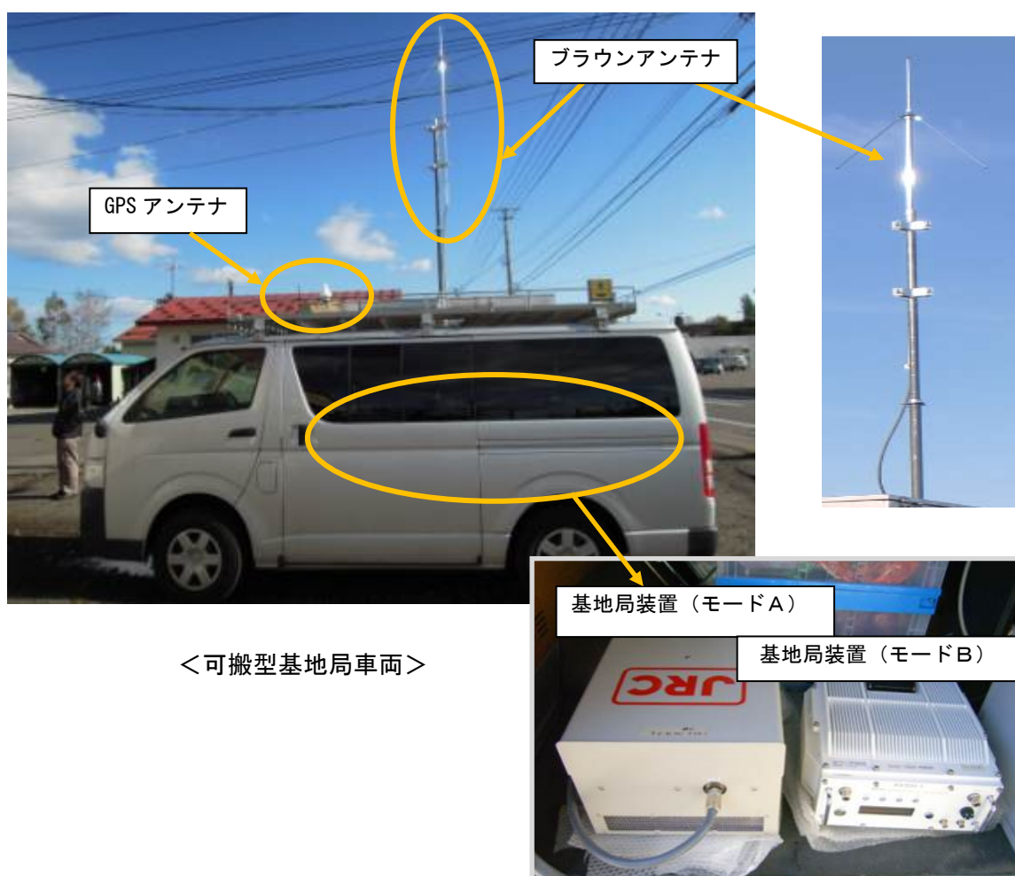
図4-8 可搬型基地局の設置状況
