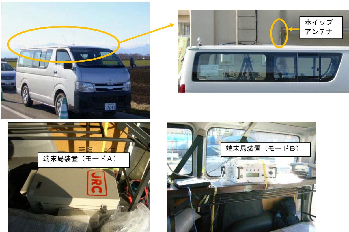
図4-9 固定型・可搬型端末局の設置状況
