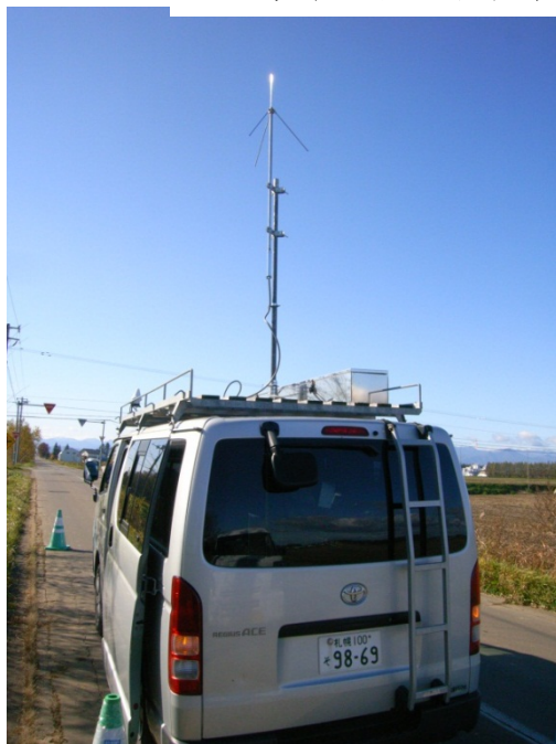
可搬型基地局(電測車)
