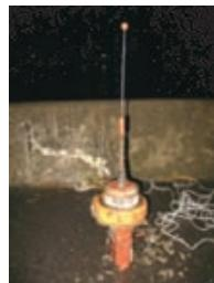
平成21年11月、当局は、船舶の遭難通報電波を発射していた衛星EPIRBについて、電波監視システム(DEURAS)により発射位置を特定し、釧路川に浮いているところを発見し電波を停波させました。
