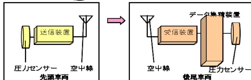
特急電車の先頭車両及び後尾車両に設置した圧力センサーで気圧変動を計測し、後尾車両に設置したデータ集積装置にデータを蓄積して、高速走行中の電車がトンネルを通過する際の車内の気圧変動のデータを収集するための特定実験試験局（平成16年度）
